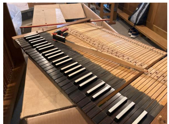
Die Tasten wurden geschliffen und poliert
