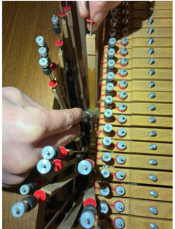
Auch die kleinsten Teile im Inneren des Spieltisches wurden gegen Schimmel behandelt
